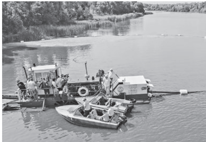
Земснаряд придбали в Херсоні. Його потужності вистачає, щоб витягнути з дна річища до 800 кубометрів пульпи на добу
