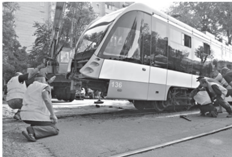
VinWay завалився на бік. Щоб його поставити на колеса, транспортники двічі піднімали вагон автокраном
