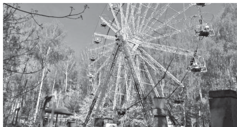
За час карантину каруселі перевірили на максимальне навантаження з допомогою мішків піску. За зиму відремонтували механічні та електричні вузли
