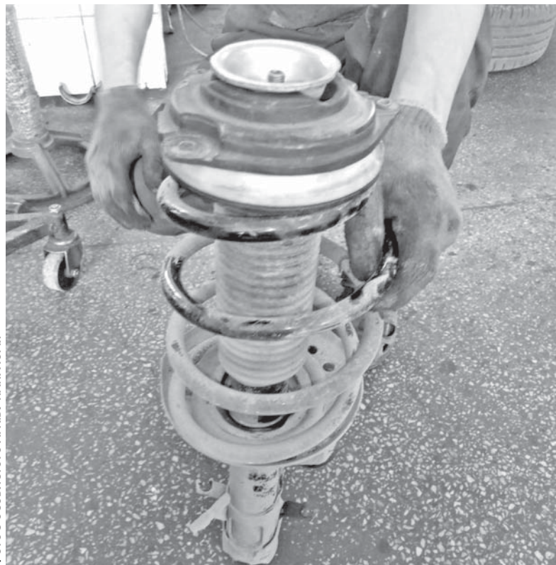
Фото амортизатора пан Юрій зробив одразу після того, як його вийняли з машини. За словами чоловіка, верхня металева деталь не має знаходитися зверху, через це машина працювала несправно
