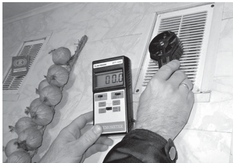
Такий вигляд має анемометр. Прилад, яким перевіряють наявність нормальної тяги
