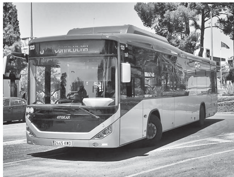
Автобус Otokar Kent C CNG працює на стисненому газі. Він має довжину 12 метрів і зможе перевозити до 101 пасажирів одночасно
