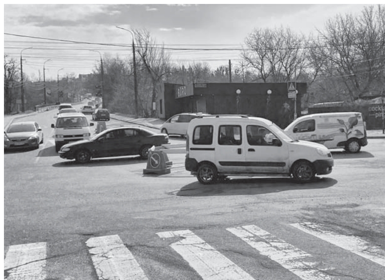
Кільцева розв'язка діє з 13 березня. Перед реалізацією проекту його вирішили перевірити в тестовому режимі: коло зробили з блоків і нанесли тимчасову дорожню розмітку
