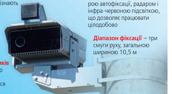
Камери знаходяться на висоті 6 м та мають сигналізацію від вандалів
