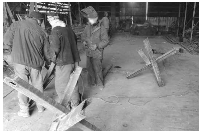
Працівники виробничого підрозділу варили протитанкові металеві «іжаки»
