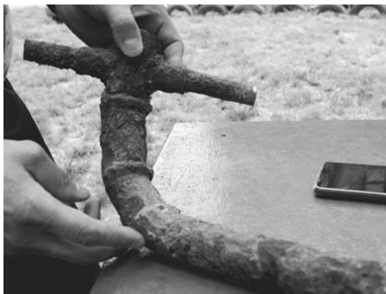
Трубу за багато років роз'їла корозія. Вона стала тонкою, наче фольга
