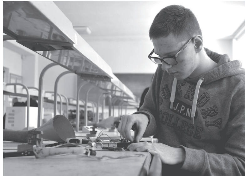
Студент технічного коледжу перевіряє справність вживаних акумуляторів. Пізніше їх використають для створення повербанка
