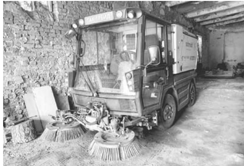
Йдеться про цю техніку. Це підмітально-прибиральна машина Schmidt Compact 200 із мийкою та вакуумним всмоктуванням
