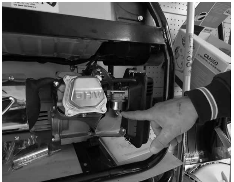
За допомогою спеціального клапана можна злити усе пальне після закінчення сезону
