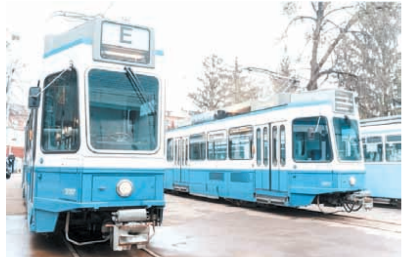
Ці трамваї не мають низькопідлогової вставки. Їхня довжина складає 21,4 метра, ширина 2,2 метра, там 50 сидячих і 54 стоячих місця
