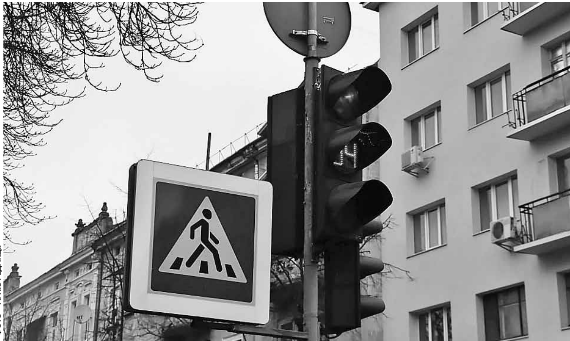
Один акумулятор забезпечує роботу світлофора до шести годин, але в мороз — орієнтовно до чотирьох
